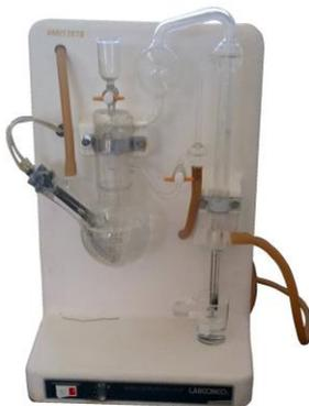
**Fig. 16.** Unidad de destilación micro Kjeldahl (determinación de proteínas).
