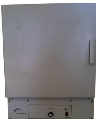
**Fig. 14.** *Estufa utilizada para determinación de humedad (horno marca Arsa)*
