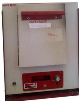
*Fig. 15. Mufla utilizada para determinación de cenizas*
