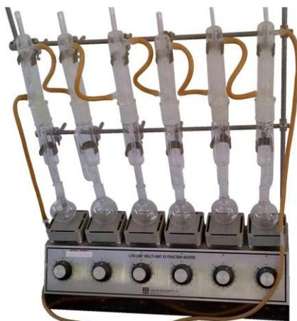
*Fig. 17. Unidad de extracción múltiple Soxhlet (para la determinación de lípidos)*
