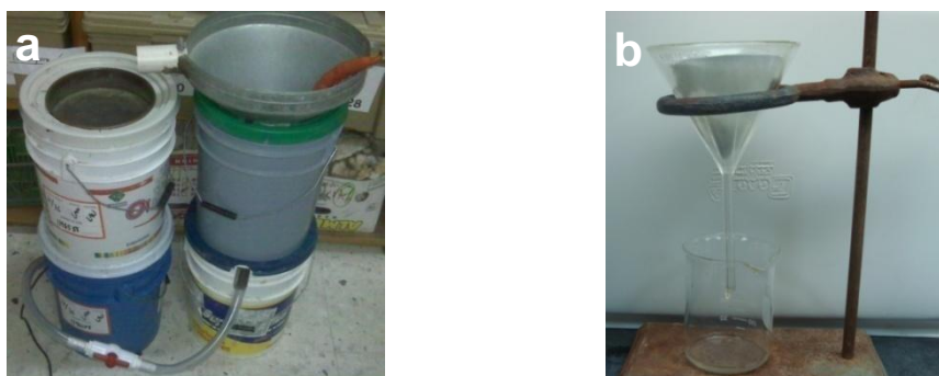
Figura 4. Métodos de separación de sedimento. a Proceso de elutriación. b Técnica de Baerman.
