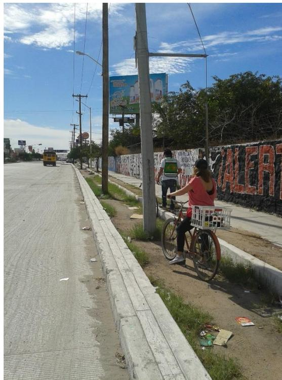
Ilustración 15. Imagen tomada sobre la ciclovía Forjadores de Sudcalifornia entre calles Jalisco y Colima. Se observan instalaciones de postes de Comisión Federal de Electricidad en medio del carril.
